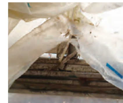
H28.11.29 折り目からの裂け
