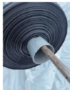
④6月23日 中芯破損状況
