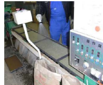
④約2ℓの水量にするため、手動で散水。
